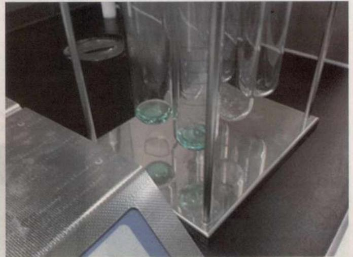
Luego se procedió a realizar la destilación de las muestras digeridas utilizando el Kjeldahl con hidróxido de sodio al 32% y ácido bórico al 4%. Una vez destilado se procedió a realizar la titulación donde se gastaron 36,8 mL de una solución 0,084 N de ácido sulfúrico, lo que nos permite obtener un porcentaje de proteínas de 60,5%.
